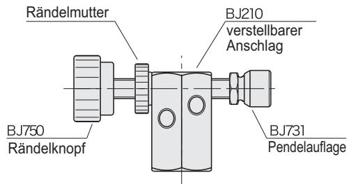
Verteilt den Spannraum auf unregelmäßige Werkstückoberflächen
