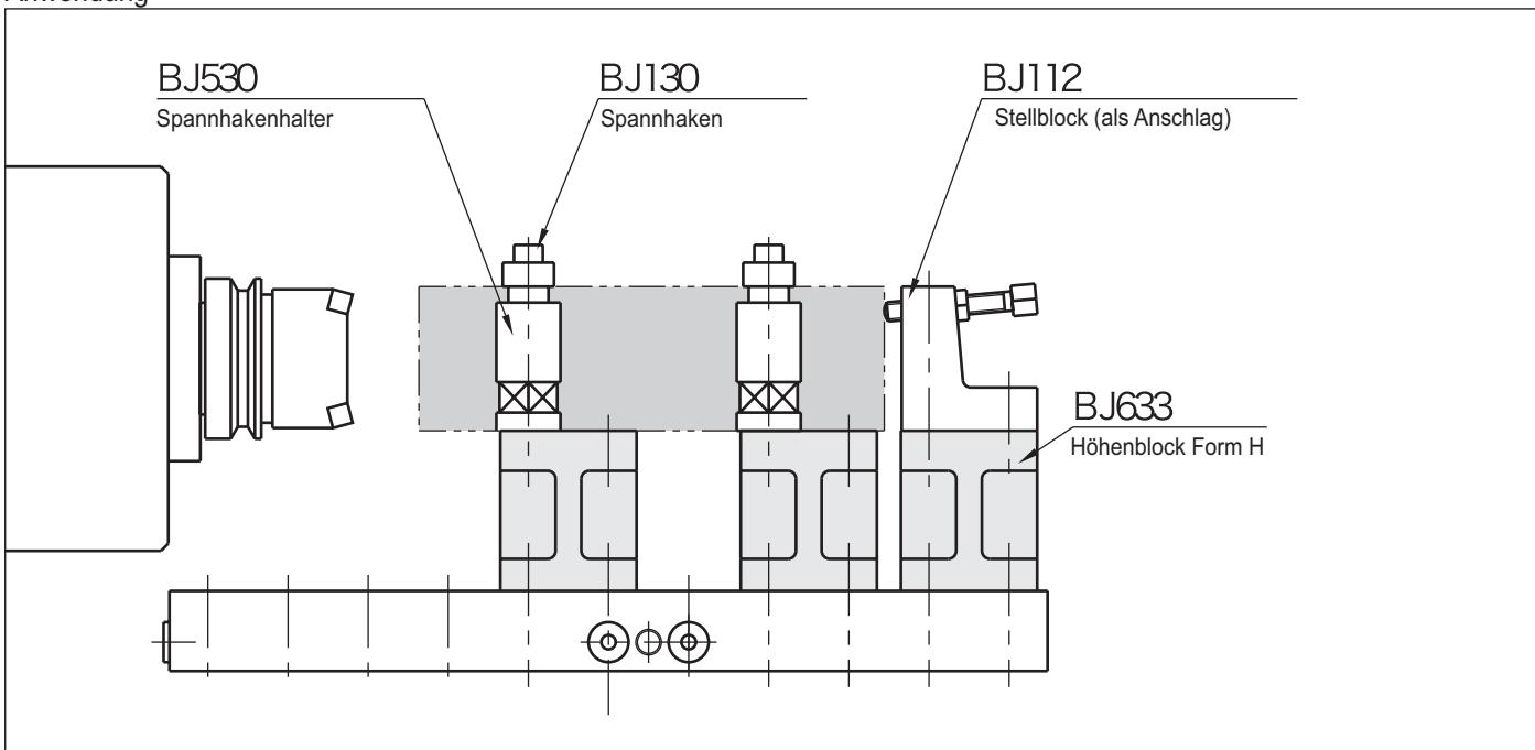
Zur Erhöhung eines Werkstückes oder von Komponenten parallel zur einer Werkzeugplatte.
