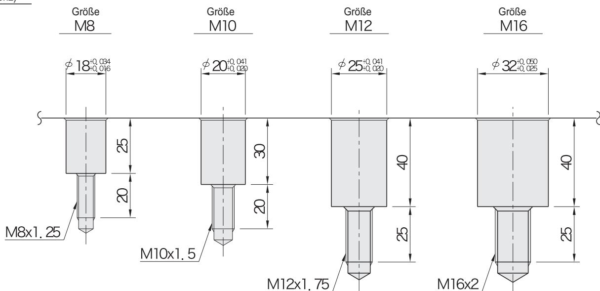
Spannhaken können direkt in die passenden Blöcke mit den oben angegebenen Aufnahmehöhlern gesteckt werden.
