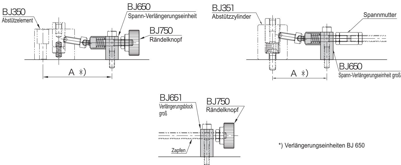
Hinweis: Im Einsatz mit einer Spann-Verlängerungseinheit BJ650 weist das Abstützelement BJ350 oder BJ351 eine geringere Abstützkraft auf.
