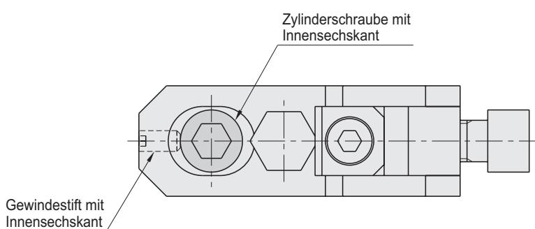
Der Gewindestift verhindert, dass der Spanner beim Einschrauben rückwärts wegrutscht, bis er mit der Zylinderschraube in Kontakt kommt.
