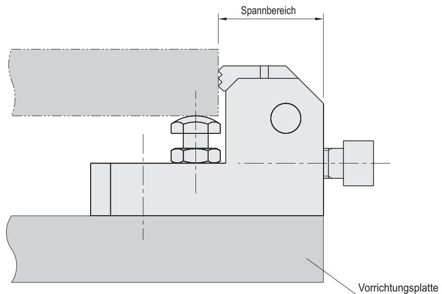
Kleinerer Spannbereich ermöglicht das Einspannen eines größeren Werkstücks.
