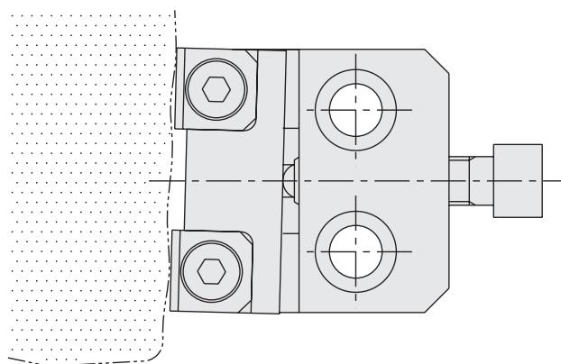
Die Backe schwenkt, um sich einer nicht bearbeiteten Werkstückoberfläche anzupassen.
