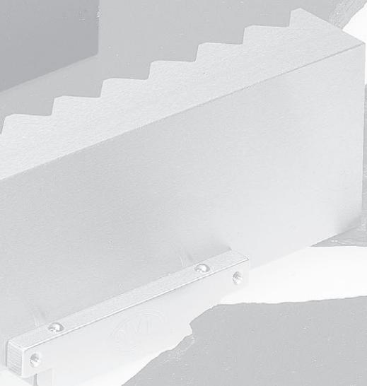
Die hydraulischen Ausgleichsbacken MULTI-GRIP OML sind zur Erhöhung der Produktivität bestimmt. Es ist über den patentierten Hydraulik-Kreislauf, welcher die Kolben ansteuert möglich, mehrere Teile in der gleichen Spannstelle des Spannsystems zu spannen. Ebenso bei Dickenunterschieden bis zu 3 mm oder auch bei unregelmäßig geformten Werkstücken.
